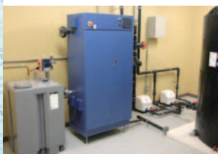
Unité de stérilisation de découpe de légumes (modèle 5000L/h_Aliments préparés)
