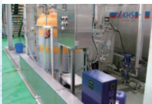
Unité de stérilisation pour le nettoyage d'une ligne de remplissage (modèle 360L/h_Boissons)
